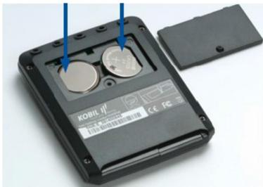
Benötigt werden zwei Batterien des Typs CR2025. Lösen Sie die Schraube auf der Rückseite und entfernen Sie den Batteriedeckel. Tauschen Sie die alten Batterien gegen neue aus und schrauben den Deckel wieder zu.
